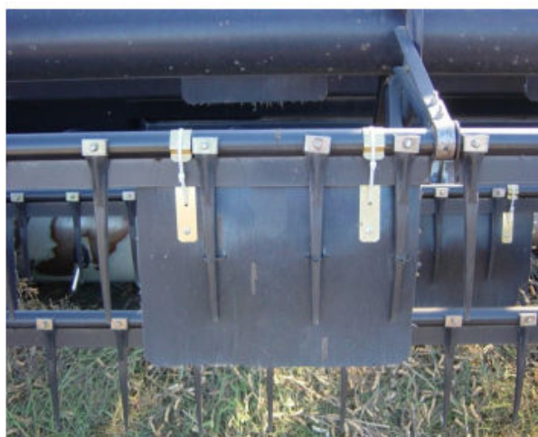
Figura 2. Gomas colocadas en el molinete para cosecha de cultivos de soja de porte bajo.
